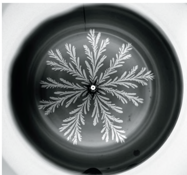
FIGUR 7. Eksperiment, hvor luft blæses igennem olie. Bemærk den forgrenede fraktale struktur. Den fraktale dimension er D=1,71 (Mathiesen o.a. 2006).
