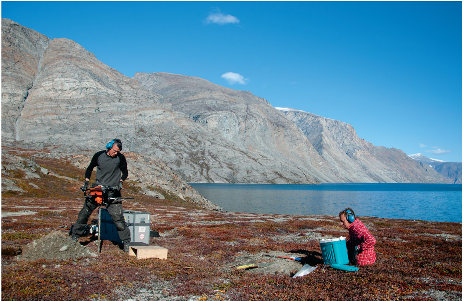
FIGUR 6. Håndboringer i Nordøstgrønland. Prøverne registreres og lægges med det samme på frys. Den håndholdte boremaskine er brugt mange steder i Grønland, og den er velegnet til at tage kerneprøver i de øverste 2-4 m af permafrosten.
