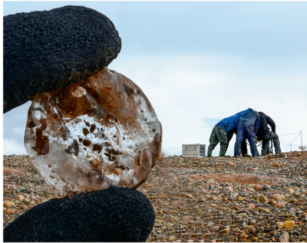
FIGUR 8. Borearbejde ved Brønlund Hus i Nordgrønland. I forgrunden ses en 4 cm tyk permafrostkerne fyldt med en massiv islinse og et stort indhold af luftbobler.
