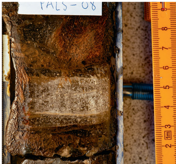
FIGUR 9. Her ses en knap 10 cm lang permafrostkerne skåret op i fryselaboratoriet i felten, hvorefter permafrostens struktur er blevet beskrevet. På den baggrund er det muligt umiddelbart at bestemme permafrostens dannelse. Denne kerne er udtaget i en pals, og prøven viser et højt indhold af organisk stof (tørvt) og en stor gennemgående linse af is fyldt med luftbobler.
